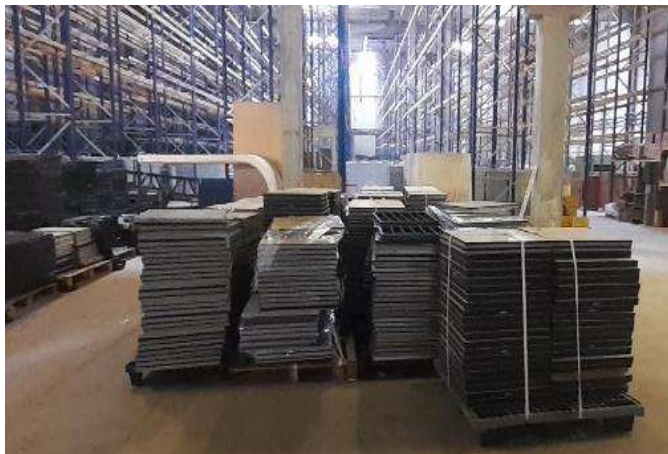
Palettes de dalles de faux-plancher requalifiés dans l'entrepôt de Möbius réemploi
